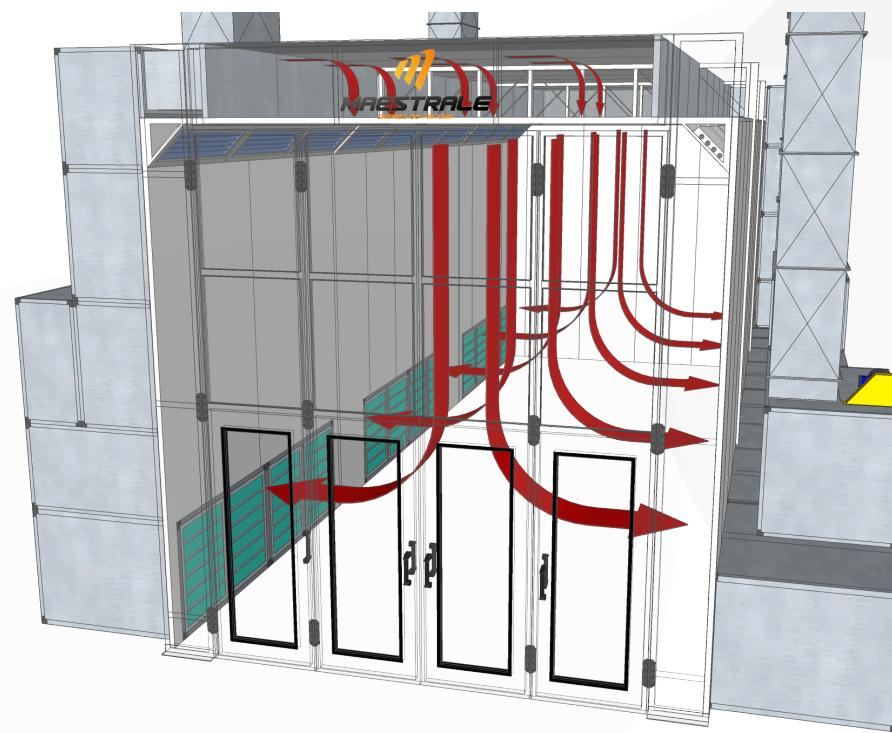
A Cabine de Pintura Twister L, com fluxo de ar side down draft, opera em pressão positiva, mantendo a pressão interna superior à externa e garantindo que apenas ar limpo circule no ambiente de pintura.
