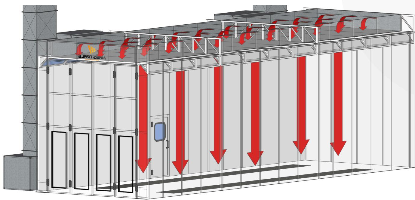
A Cabine de Pintura Twister P com fluxo de ar down draft, trabalha em pressão positiva. O ar é constantemente insuflado para dentro da cabine, impedindo a entrada de impurezas externas e assegurando um ambiente totalmente controlado para o processo de pintura.
