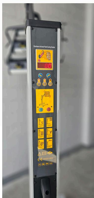
Sistema eletrônico de controle digital, que permite ajustar tempo, intensidade e modo de operação com total precisão.
