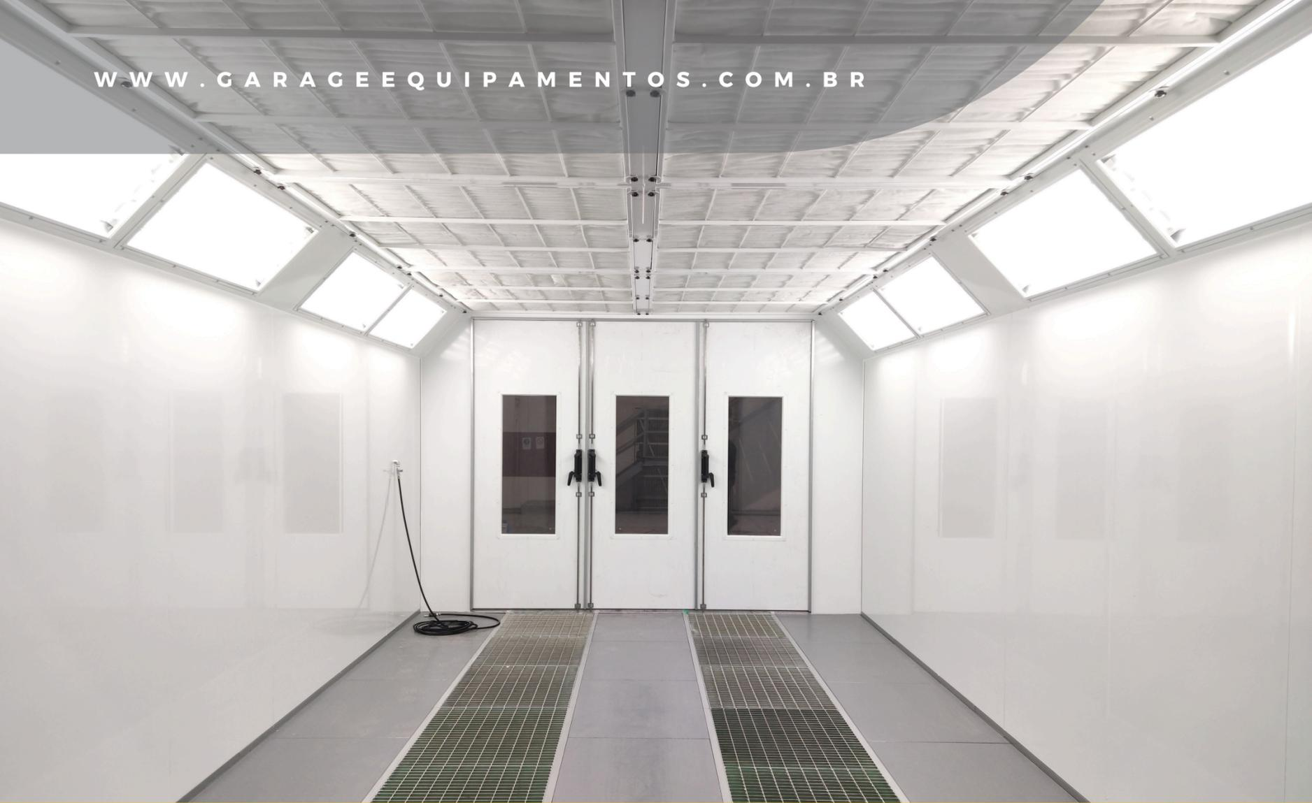
A Cabine de Pintura **Tramontana** é pressurizada com ventilação por insuflamento, promovendo um fluxo de ar descendente por pressão positiva, conhecido como *Down Draft*.
