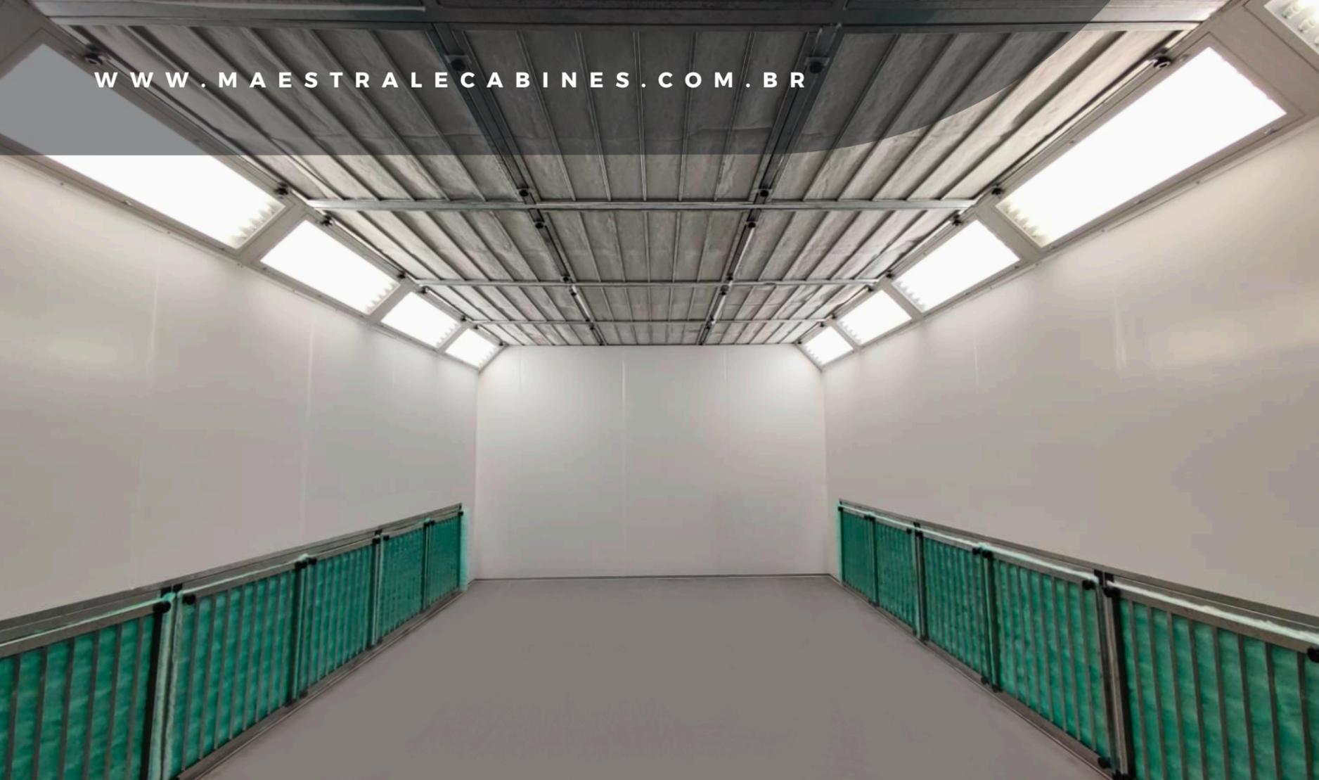
**A Cabine de Pintura automotiva modelo LEVANTE** oferece alta flexibilidade, podendo ser adaptada a diferentes perfis de projeto. Com ambiente pressurizado por pressão positiva e sistema de funcionamento *Side Down Draft*, foi desenvolvida para proporcionar um fluxo de ar controlado e limpo, eliminando o excesso de *overspray* (névoa de tinta) e contaminantes, assegurando um acabamento de excelência.
