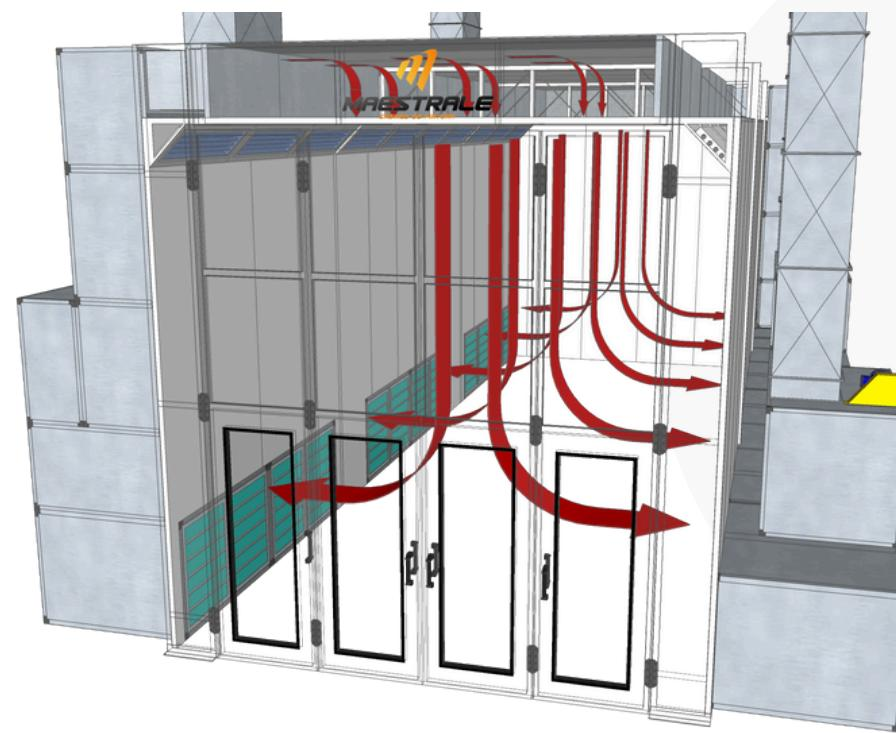
A Cabine de Pintura SUPREME Serie L, com fluxo de ar side down draft, opera em pressão positiva, mantendo a pressão interna superior à externa e garantindo que apenas ar limpo circule no ambiente de pintura.
