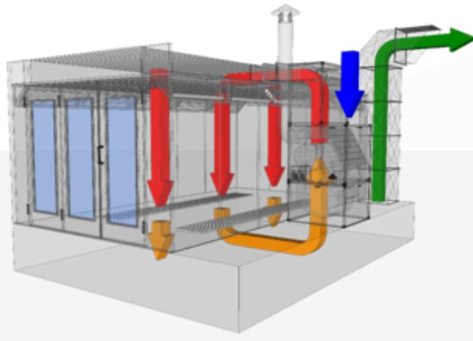
A Tornado opera com pressão positiva, garantindo que o ar puro seja constantemente insuflado para dentro do ambiente de pintura. Seu sistema de fluxo Down Draft promove a circulação vertical do ar. O ar filtrado entra pelo teto e desce uniformemente até o piso, envolvendo todo o veículo. Esse movimento remove poeira, vapores e o over spray em suspensão, criando as condições ideais para um acabamento uniforme e de alto padrão.
