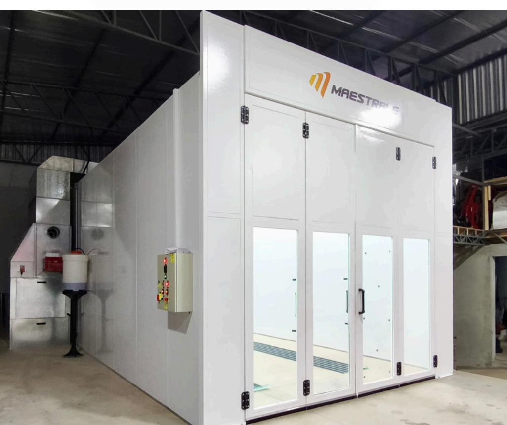
Pintura e secagem no mesmo ambiente, com ventilação uniforme e tecnologia que inclui inversor de frequência e reaproveitamento de ar quente.
